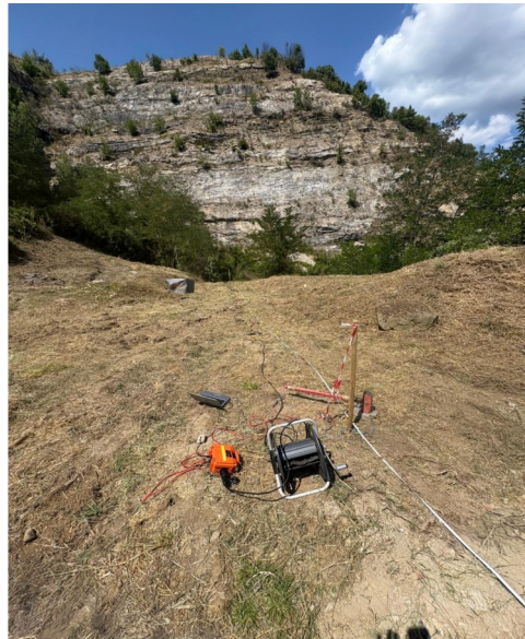
Foto 1: particolare esecuzione prova MASW
